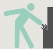
Antes de trabajar con máquinas o equipos, aisle toda forma de energía peligrosa, asegúrela con trabas y etiquetas, y luego verifique que el estado de energía sea cero.
