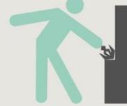
Bevor Wartungs- oder Instandsetzungsarbeiten an Maschinen oder Anlagen begonnen werden, muss sämtliche Zufuhr gefährlicher Energien abgeschaltet, gegen Wiedereinschalten mit Schloessern und Kennzeichnungen gesichert und der Null-Energie Status überprüft werden.
